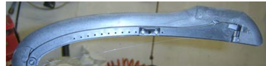
Bohrung im Mückenputzer
