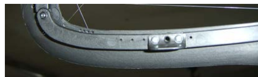
Bohrung im Mückenputzer
